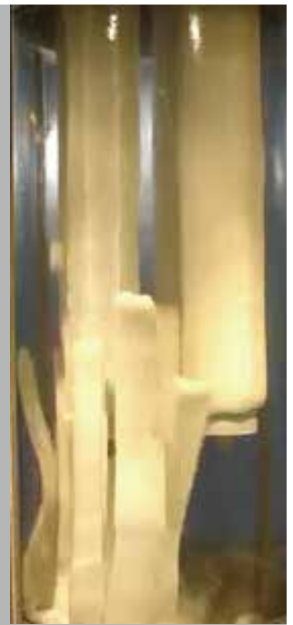
实拍吹落滤饼照片
